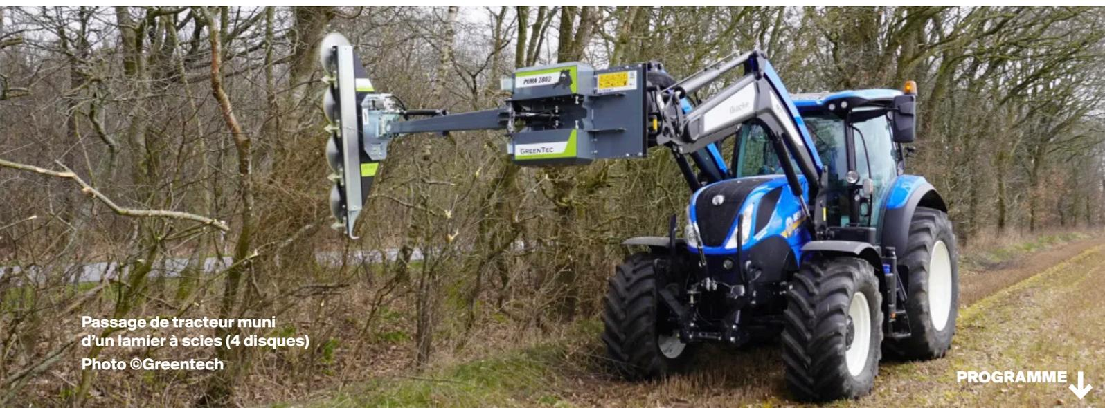
Passage de tracteur muni d'un lamier à scies (4 disques)
